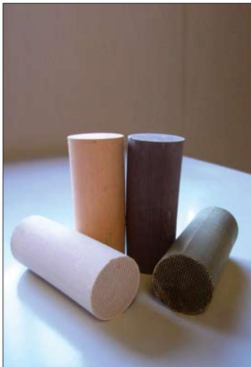
*Monoliti supportati utilizzati nella sperimentazione*
