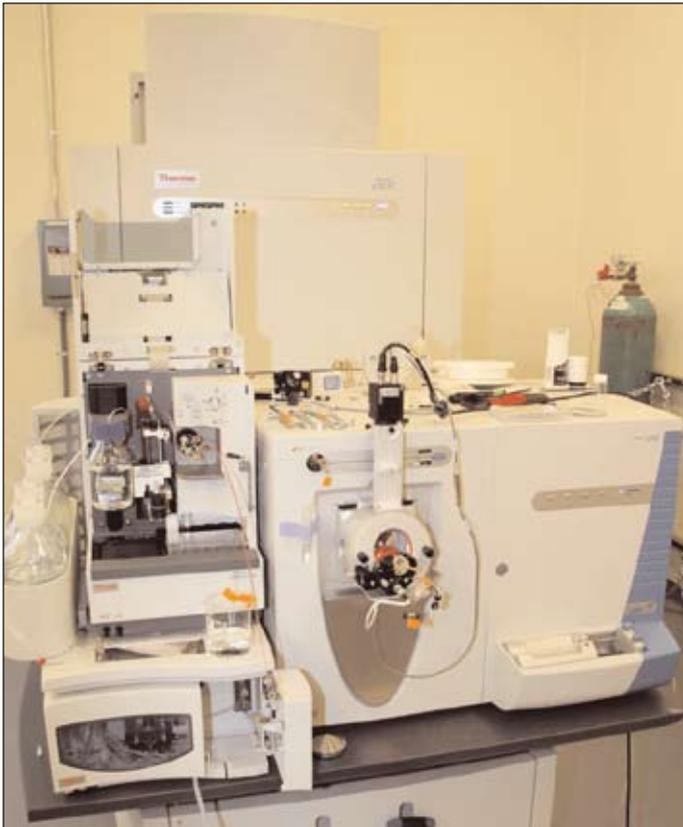
*Uno strumento che combina la Spettrometria di Massa (MS) con FTICR (Fourier Transform Ion Cyclotron Resonance)*
